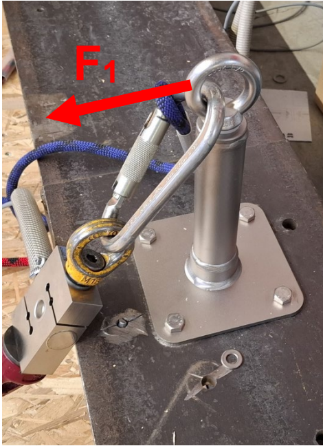
Bild 7: Prüfaufbau 1, Anschlageneinrichtung, Typ: ABS-Lock® X-SR mit Hülse (hier: Stützenhöhe 200 mm)
