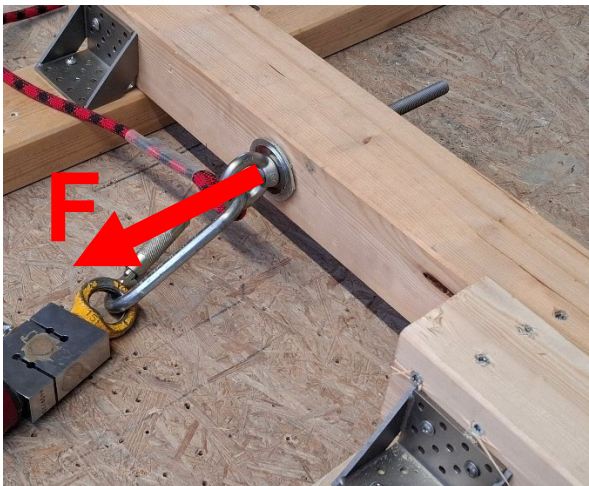
Bild 19: Prüfaufbau C, Anschlageneinrichtung, Typ: ABS-Lock® III-HW
