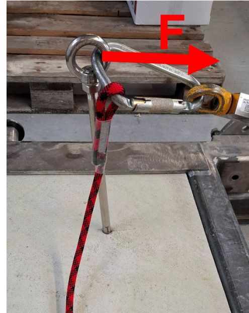
Bild 22: Prüfaufbau F, Anschlagereinrichtung, Typ: ABS-Lock® III-B
