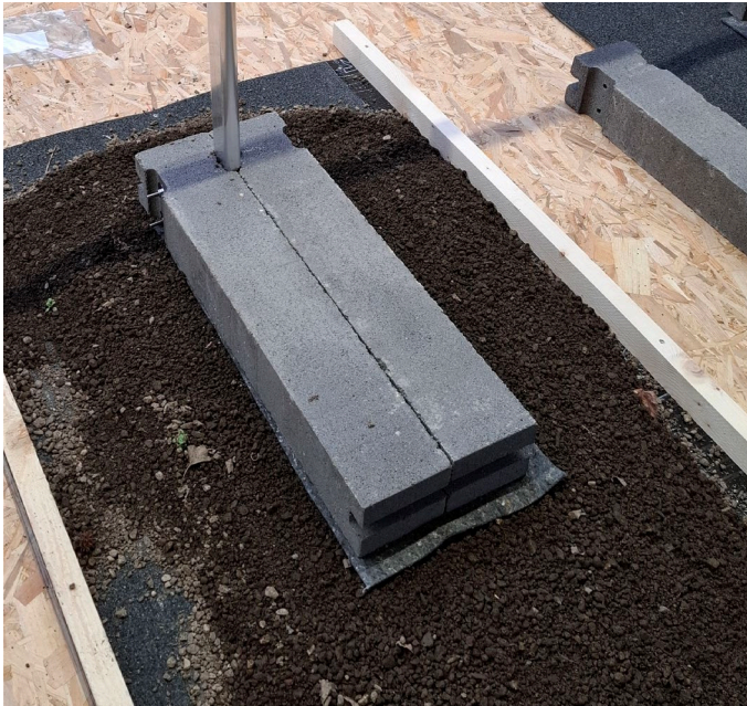
Bild 18: Simulierte Bauwerksoberfläche aus Substrat
