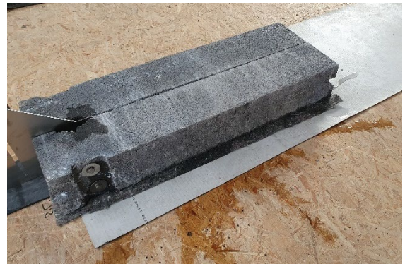
Bild 17: Simulierte Bauwerksoberfläche aus PVC-Folie mit rutschhemmender Matte
