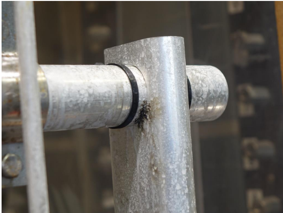
Bild 24: Prüfmuster TS03 S01 nach der Belastung mit 3x 100 kA (10/350 \mu s) – Überschlagsspuren an Pfosten und Handlauf (vo./re./ob.).
