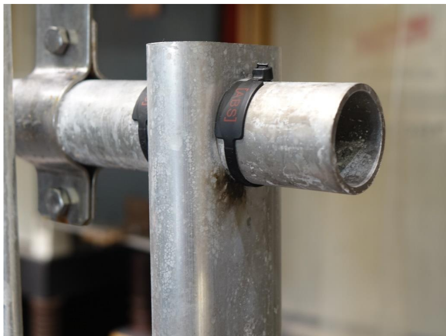
Bild 13: Prüfmuster TS01 S01 nach der Belastung mit 3x 100 kA (10/350 µs) – Überschlagspuren an Pfosten und Handlauf (vo./re./ob.).
