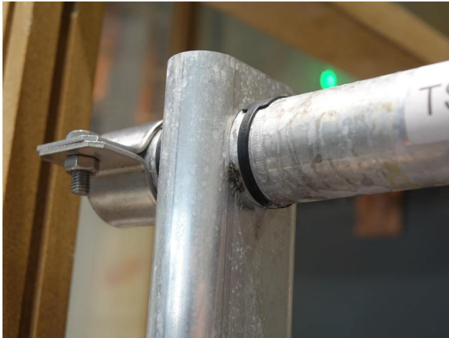
Bild 16: Prüfmuster TS01 S01 nach der Belastung mit 3x 100 kA (10/350 \mu s) – Überschlagsspuren an Pfosten und Handlauf (vo./li./ob.).
