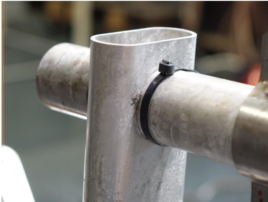
Bild 14: Prüfmuster TS01 S01 nach der Belastung mit 3x 100 kA (10/350 \mu s) – Überschlagsspuren an Pfosten und Handlauf (hi./re./ob.).
