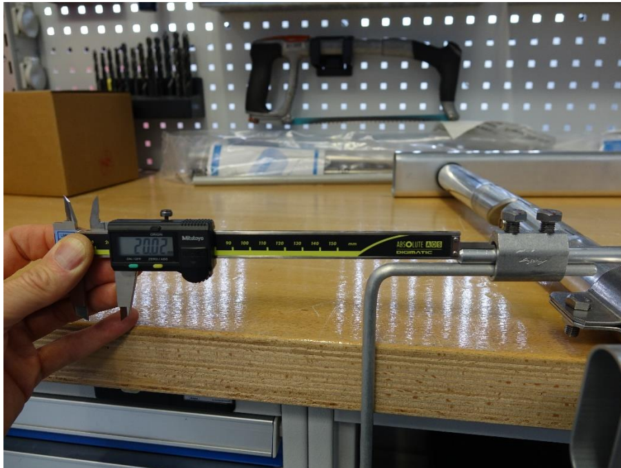
Bild 32: Messung der Leiterlänge nach Verbinder – Trennmuffe zu Fangstange.
