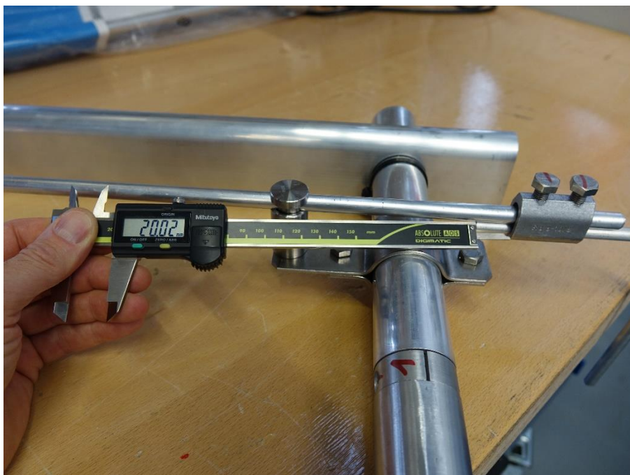
Bild 33: Messung der Leiterlänge nach Verbinder – Trennmuffe zu Ableitung.
