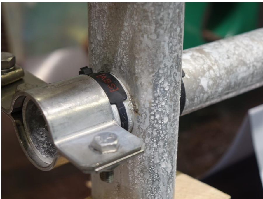
Bild 21: Prüfmuster TS02 S01 nach der Belastung mit 3x 100 kA (10/350 \mu s) – Überschlagsspuren an Pfosten und Knielauf (vo./li./un.).
