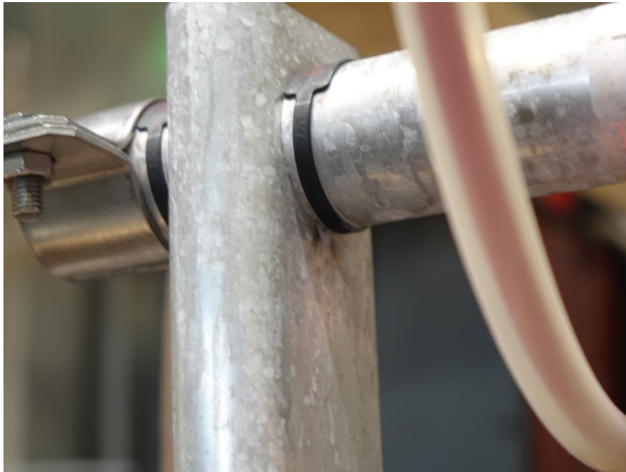
Bild 20: Prüfmuster TS02 S01 nach der Belastung mit 3x 100 kA (10/350 \mu s) – Überschlagsspuren an Pfosten und Handlauf (vo./li./ob.).
