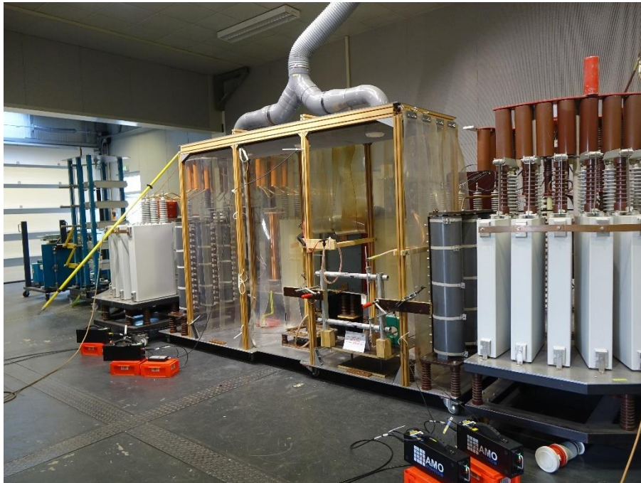
Bild 8: Elektrische Prüfung – Gesamtansicht des Aufbaus im 2x 200 kA (10/350 µs) Crowbar Impulsstrom Generator.
