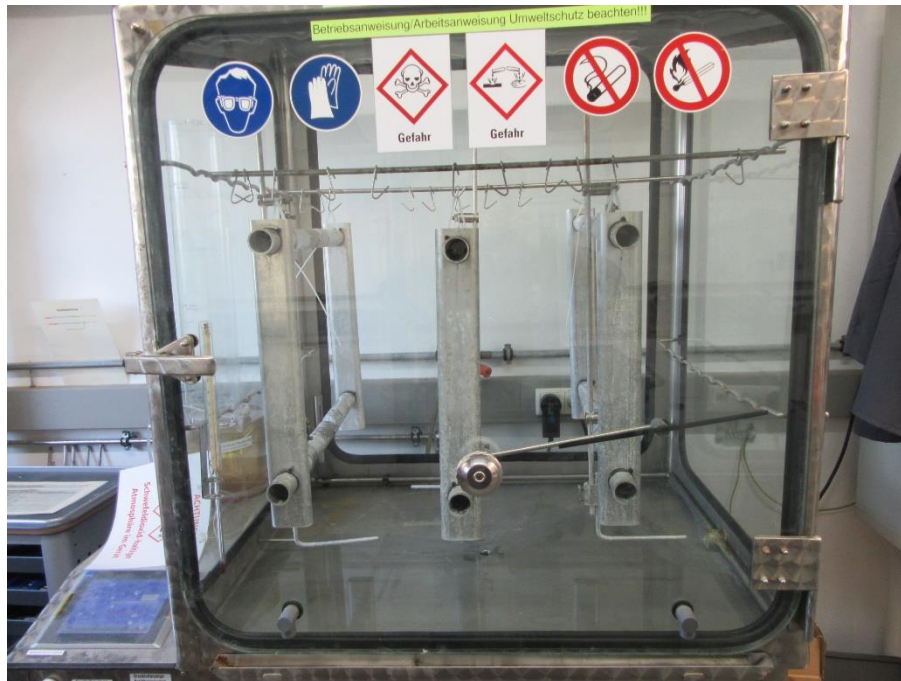
Bild 6: Prüfmuster im Gerät für feuchte schwefelige Atmosphäre.
